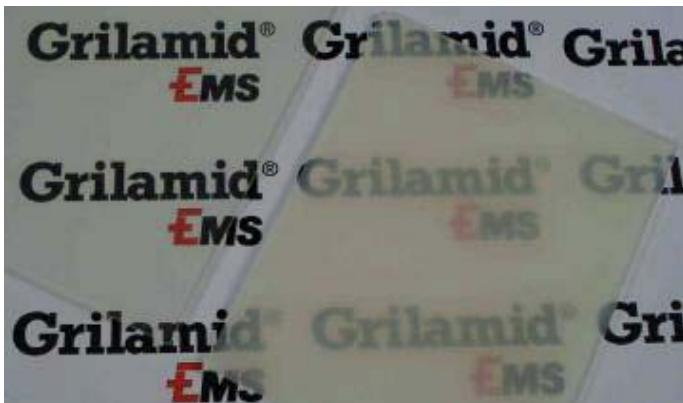
Abb. 2: Thermotropes Polymer der EMS Chemie. Die hohe Transmission im kalten Zustand (links) wird aufgrund von Streuung im heißen Zustand (rechts) deutlich reduziert. (Quelle: EMS)
